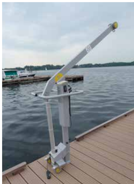
Mobiele tillift voor gebruik op de steiger
